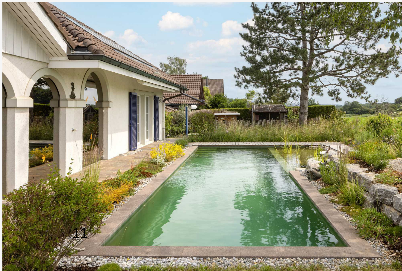
Integrovaná biologická filtrační zóna osázená kyperskou trávou plynule navazuje na nízkou kamennou zídku s dekorativním porostem.
